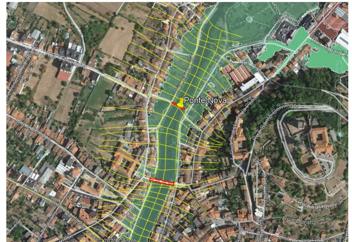
Secciones de la modelización HEC-RAS superpuestas sobre ortoimagen y con la capa de zona de inundación de la CHMS para T500.
