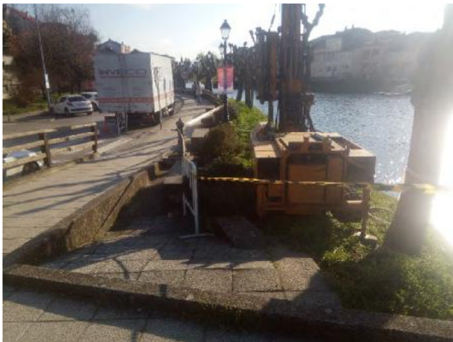
Fotografía 8: Ensayo de penetración dinámica PD-1.
