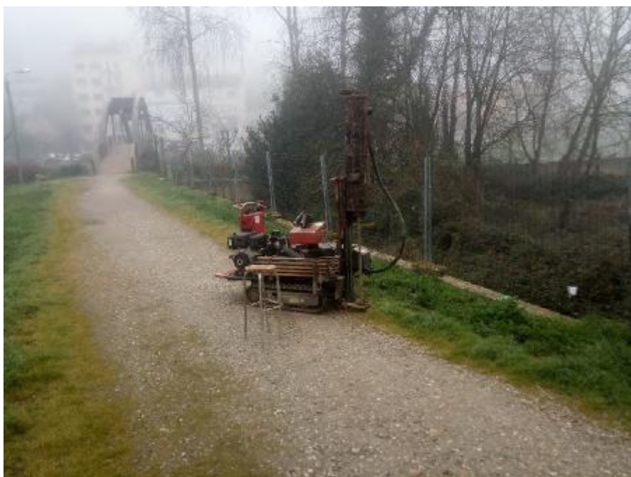
Fotografía 8: Ensayo de penetración dinámica PD-1.
