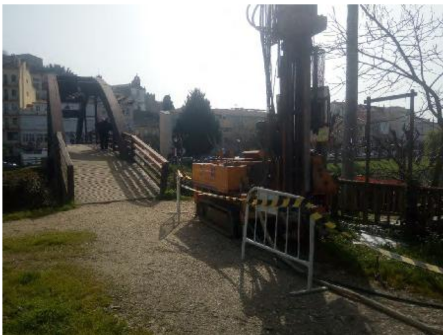
Fotografía 6: Máquina de sondeos emplazada en el sondeo S-2.
