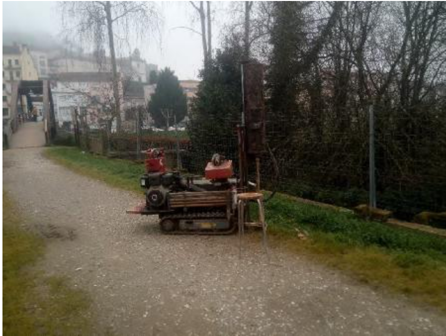
Fotografía 10: Ensayo de penetración dinámica PD-3.
