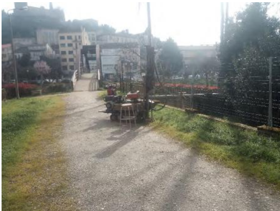
Fotografía 10: Ensayo de penetración dinámica PD-3.
