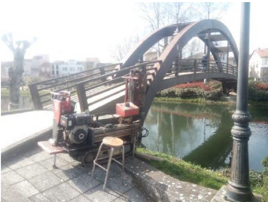
Fotografía 12: Ensayo de penetración dinámica PD-5.
