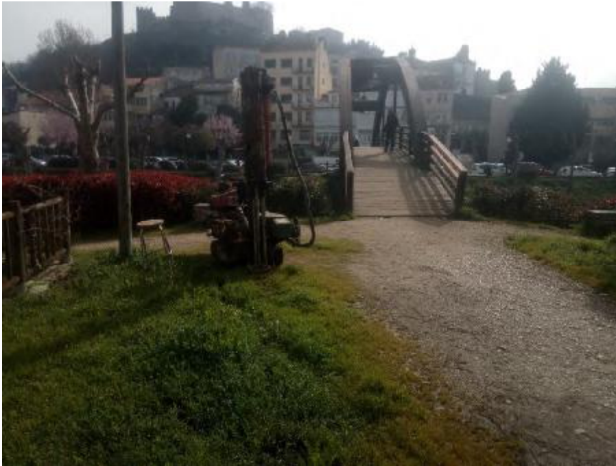
Fotografía 12: Ensayo de penetración dinámica PD-5.
