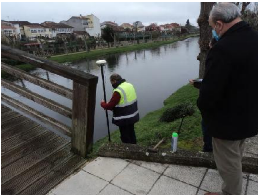
Fotografía 4: Trabajos de topografía realizados para el emplazamiento de los ensayos de campo.
